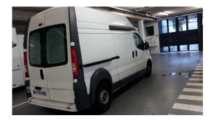
L'aménagement de certains véhicules génère également un confort pour les utilisateurs. Ainsi, l'installation de hayon ou de châssis amovible évite le port manuel de charges lourdes (caisses) et permet de mettre sur roulette des caisses ou de transporter directement dans le véhicule des chariots sur roulette (exemple d'aménagement d'un châssis amovible sur Trafic Renault, 13 000 € TTC).
